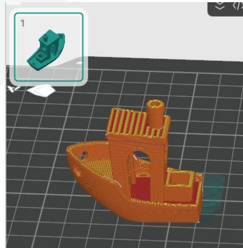
Standard-Modell wird mit (negativem) Würfel kombiniert, um das Heck abzuschneiden
